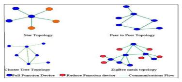
Fig. 3. ZigBee Topologies
